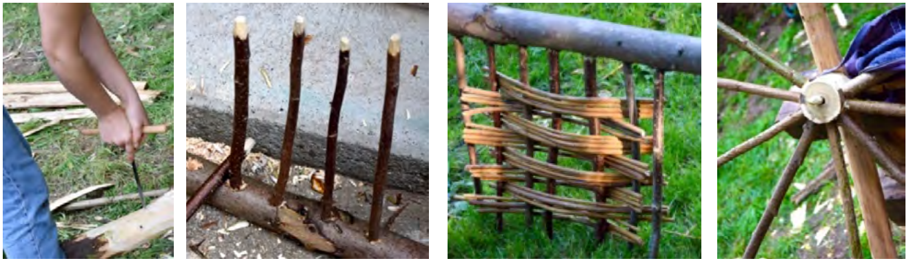
Abb. 36-37 Das Einbohren der Löcher mit dem Spindelbohrer ist ein langsamer, gut kontrollierbarer Vorgang. Größere Löcher können durch kleiner vorgebohrt werden. Bei tiefen großen Löchern kann die Kraftanstrengung erheblich werden. Das gute festhalten oder Einspannen des Stammes ist wichtig. In die Löcher können dann die angespitzten Haselstecken eingeklopft werden. Abb. 38-39 Stämme oder Äste mit einseitig eingesteckten Haselstecken, die auch auf der abstehenden Seite etwas zugespitzt sind, können als gesamte Struktur in die weiche Erde eingeschlagen werden. Damit ist das Gittergefüge stabil und Weidenruten oder andere Ruten lassen sich gut einziehen. Das Bohren und Stecken eignet sich natürlich auch dazu bewegliche Holzstrukturen zu bauen, die an Maschinen früherer Ingenieurskunst erinnern (wie etwa bei Kränen, Mühlen, Windrädern, etc.)
