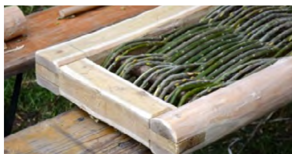
Abb. 41-42 Hier das exakte Zuspitzen und Anpassen der Gitterstäbe für den Rahmen der Sitzfläche der Holzbank, und die noch nicht zusammengefühten Rahmenhölzer, an denen die Bohrungen erkennbar sind. Zusammenfügen des Holzrahmens mit den „Gitterstäben“. Rechts sieht man die Zapfenverbindungen, die mit eingeschlagenen handgeschnittenen Dübeln gesichert werden. Ebenso ist hier schon die frisch geschnittene Weide in das Gittergefüge eingezogen.
