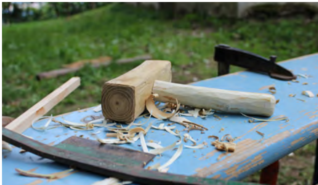
Abb. 40 Einfache Werkzeuge wie Klöpfel, Schlögel, Rechen, Gabel, lassen sich mit einiger Erfindungskraft durch das Bohren und Stecken und einschlagen zugeschnittener Zapfen gut anfertigen.
