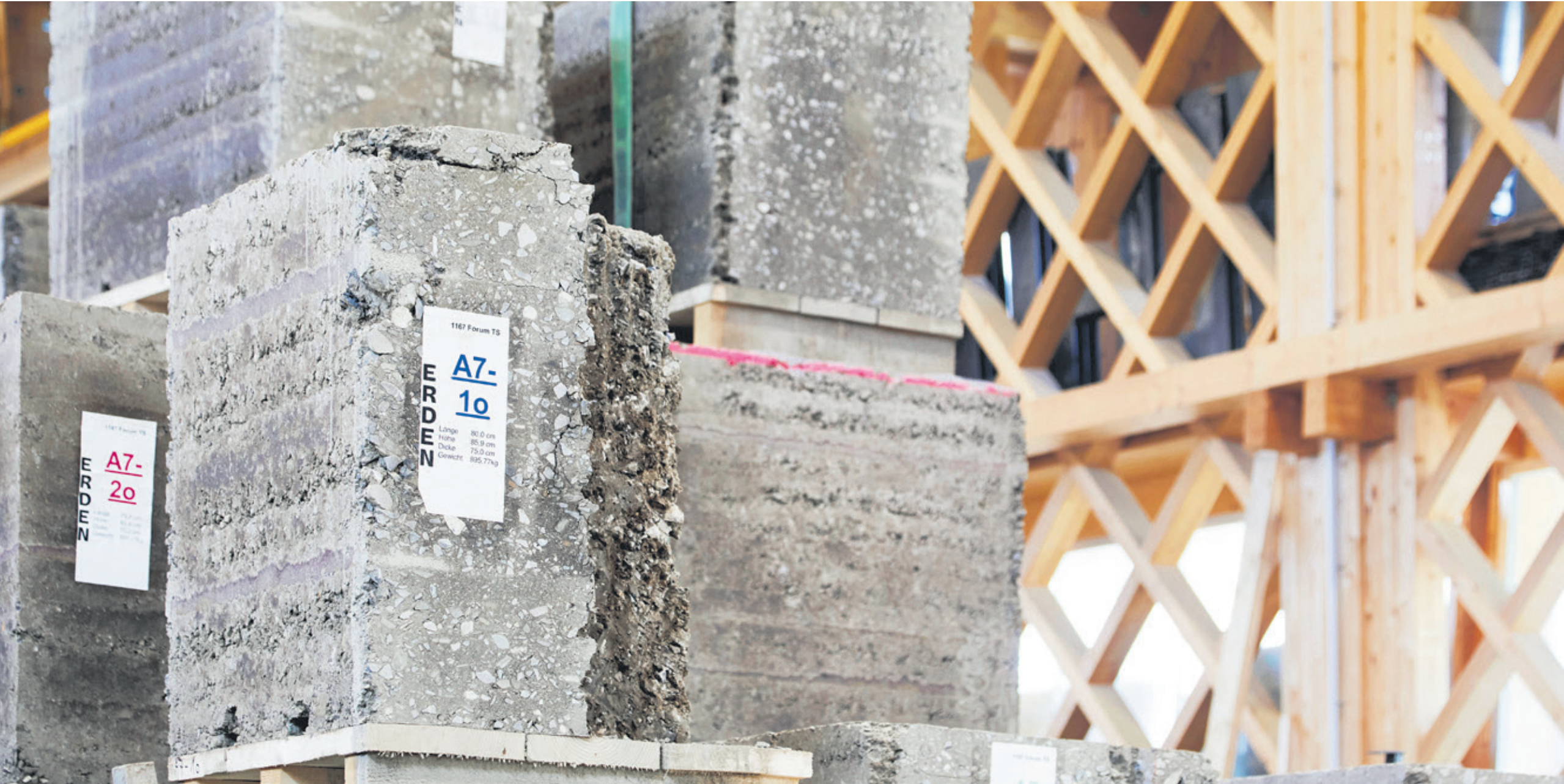
PRODUKTIONSSTRASSE Die gestampften Blöcke werden mit einem Kran aus der Produktionsstraße gehoben.
