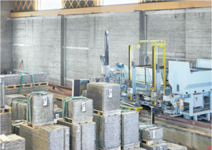
VORFERTIGUNG Die gestampften Blöcke verbleiben zur Trocknung und Lagerung in der Halle.
