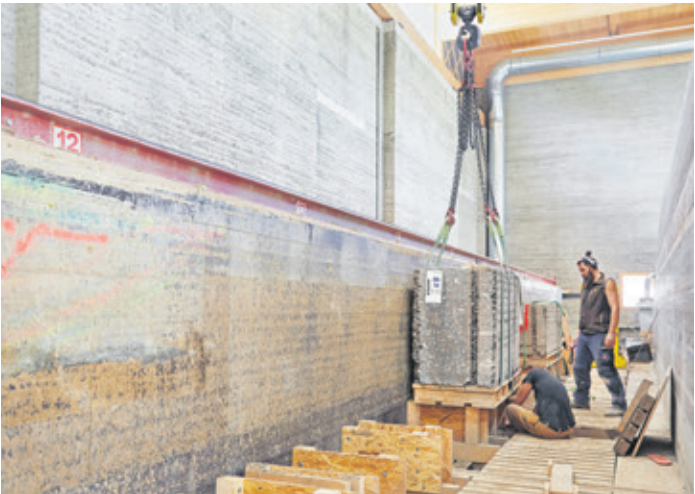
VORFERTIGUNG Die gestampften Blöcke verbleiben zur Trocknung und Lagerung in der Halle.
