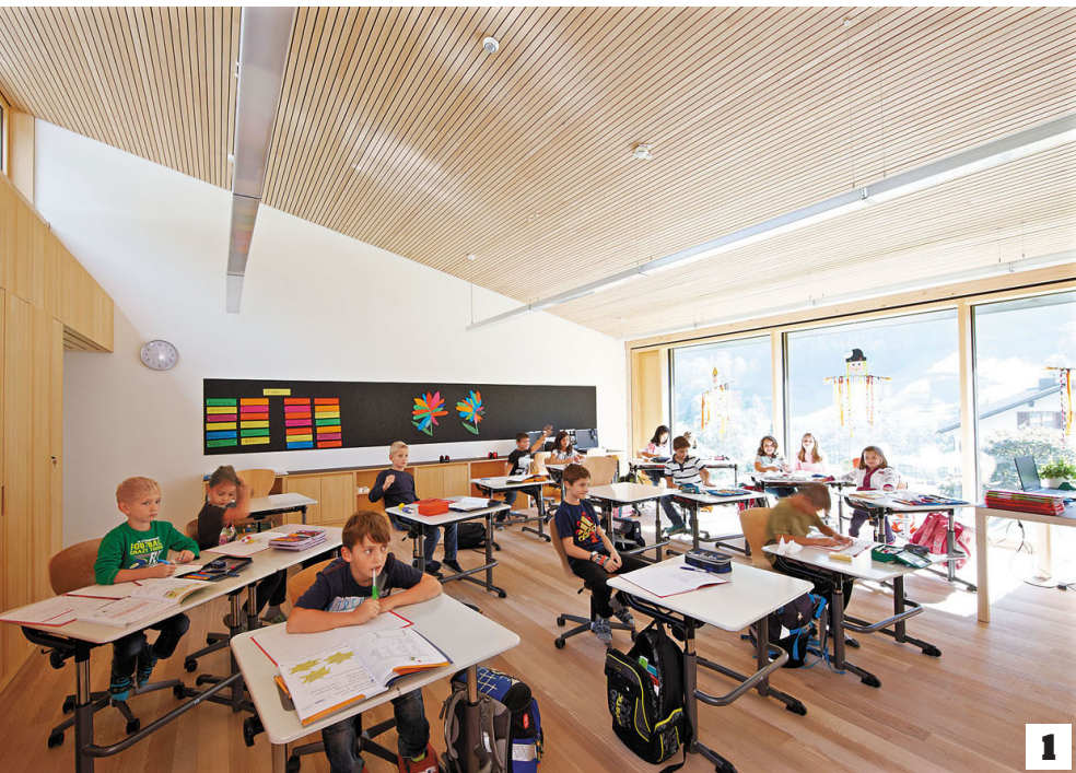
1 Berg und Tal – beide sind dank Pultdach im Klassenzimmer präsent. Wenn im Winter die direkte Besonnung ausbleibt, lassen die Oberlichter das Reflexionslicht der verschneiten Berghänge herein.
